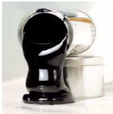
Figura 1: Ejemplo de ligante hidrocarbonado básico.
